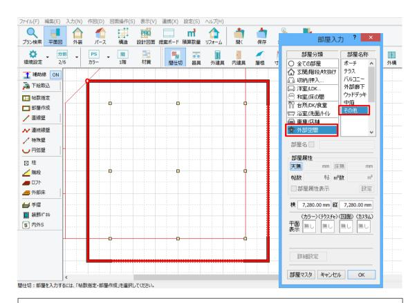
入力済み「ガレージ」の部屋分類を「外部空間」としてください。 部屋分類を「外部空間」とすることで、ガレージ内の壁が外壁として表現されます。
